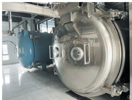
大量処理に応え、工場の安定稼働を支える、花房ENGの①中型FD設備 (脱水量130〜400L)、②大型FD設備(脱水量600〜3000L)
